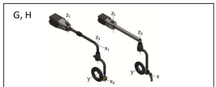
G: 0 ~ 15 kg対応。クイックチェンジ付 X1: 360°回転。45°毎固定可 X2: 360°回転 Y: 360°回転 Z1: 右左90°回転 Z2: 360°回転 固定不可
