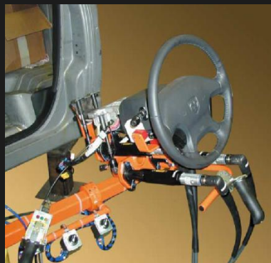
ステアリングコラムの締め付け
